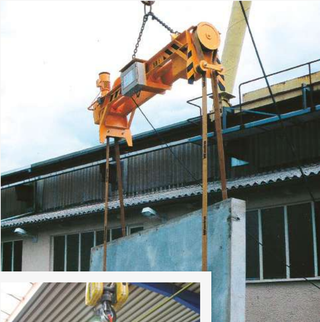
Wendetraverse mit motorischem Wendeantrieb für unterschiedliche Güter
