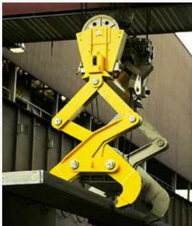
Doppelbrammenzange in mechanischer Scherenbauweise mit motorischer Greifweitereinstellung
