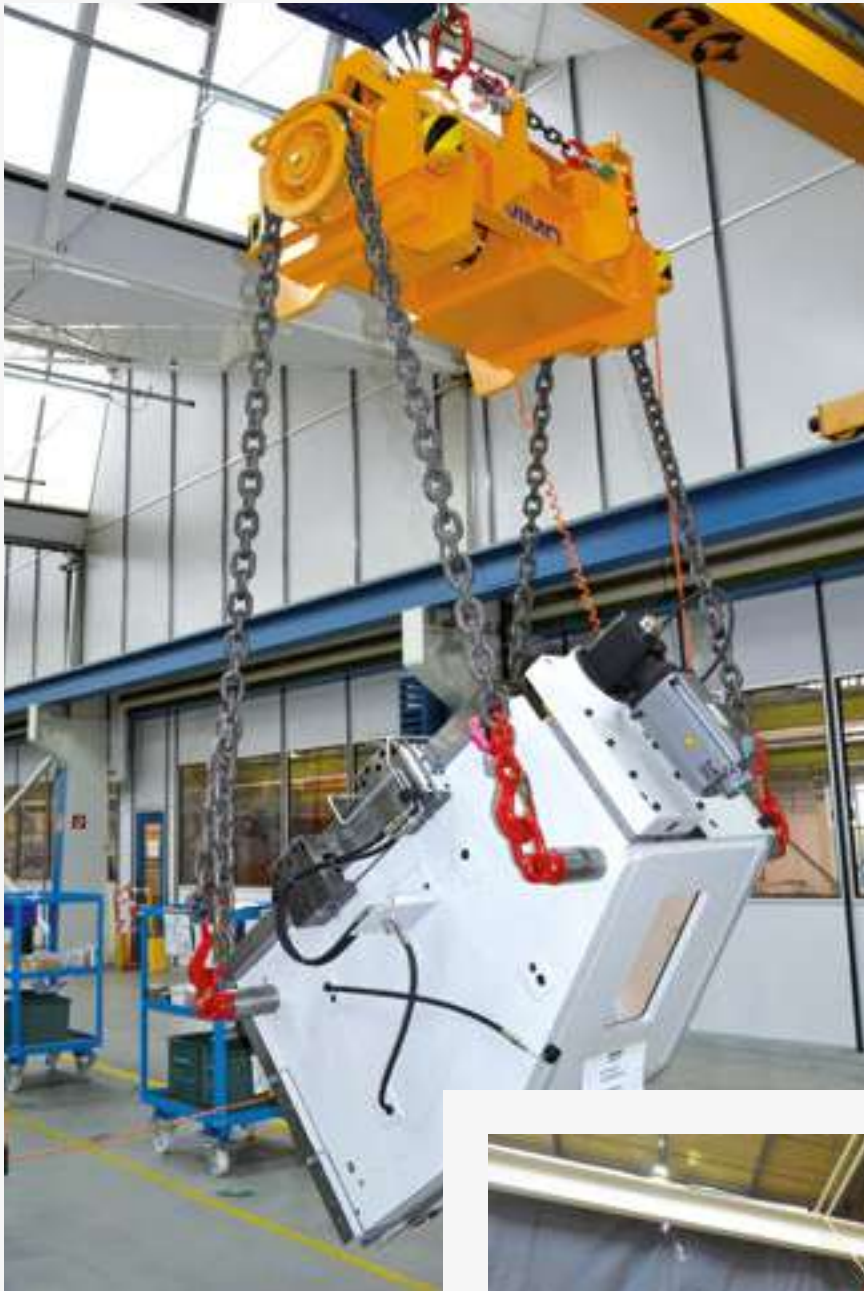
Wendetraverse mit motorischem Wendeantrieb
