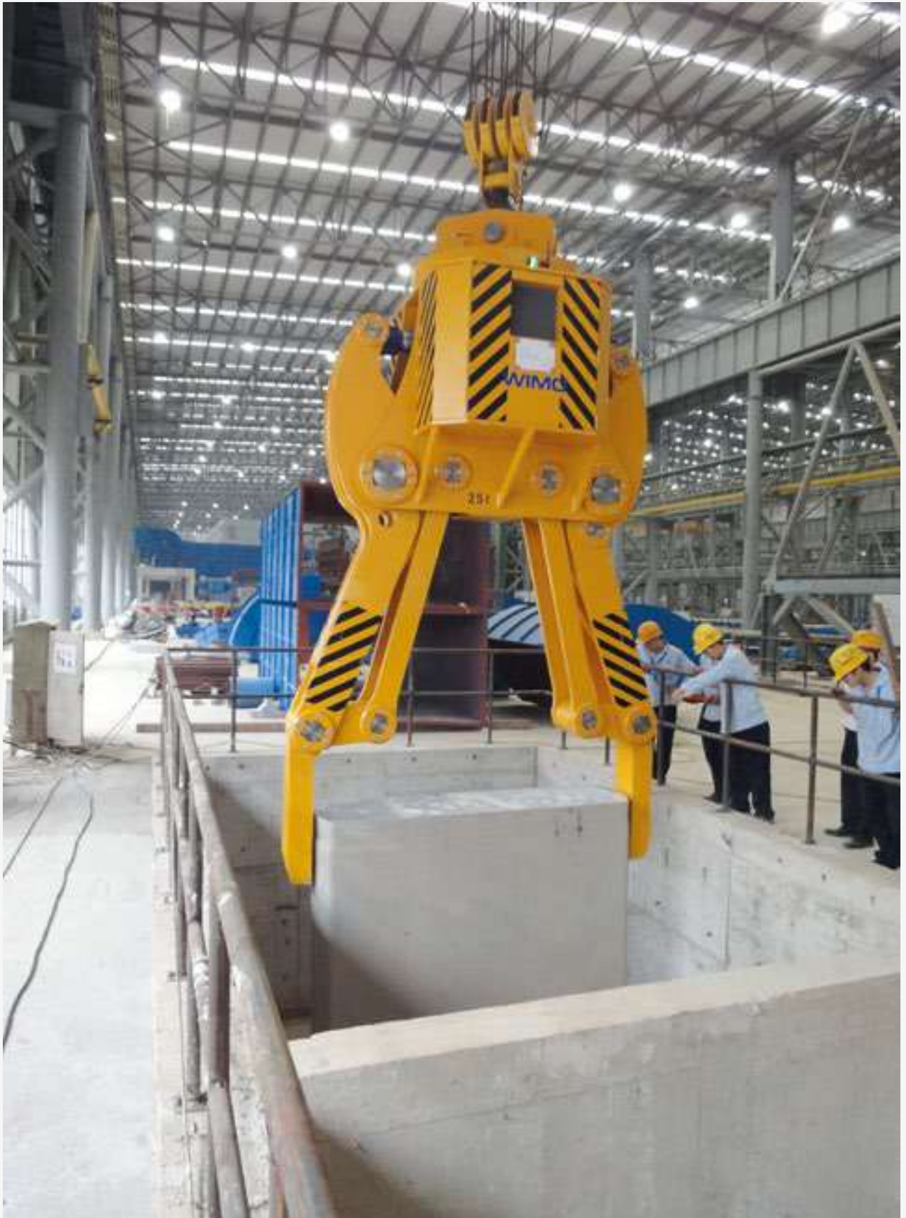
Brammenzange mit hydraulischem Zangenantrieb für das Aufrichten, Ablegen und den vertikalen Transport
