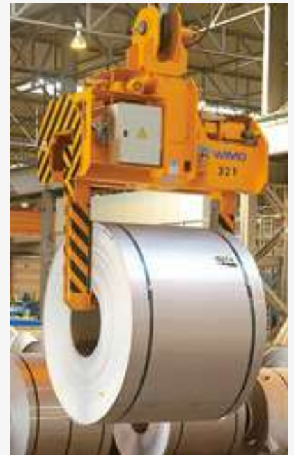
Teleskop-Coilzange mit Kettenantrieb und motorischer Horizontal-Dreheinrichtung
