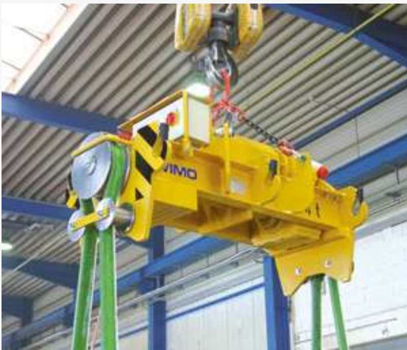
Wendetraverse mit motorischem Wendeantrieb für unterschiedliche Güter
