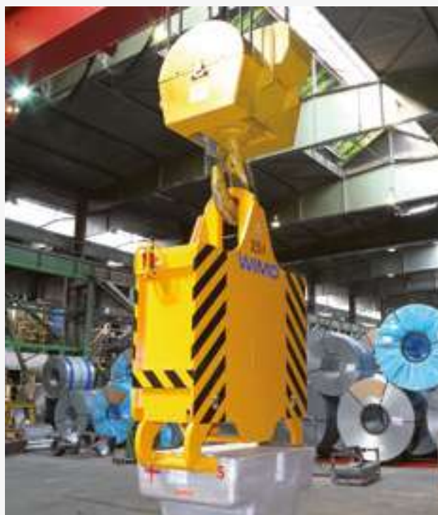
Zinkbarrenzange mit Spindeltrieb für die Beschickung von Schmelzöfen
