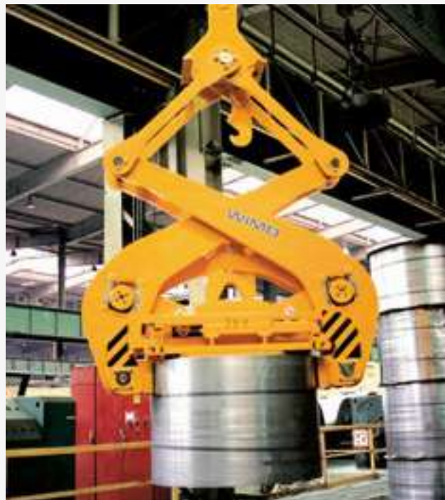
Vertikal-Coilzange in mechanischer Ausführung mit doppelseitiger Lastaufnahme
