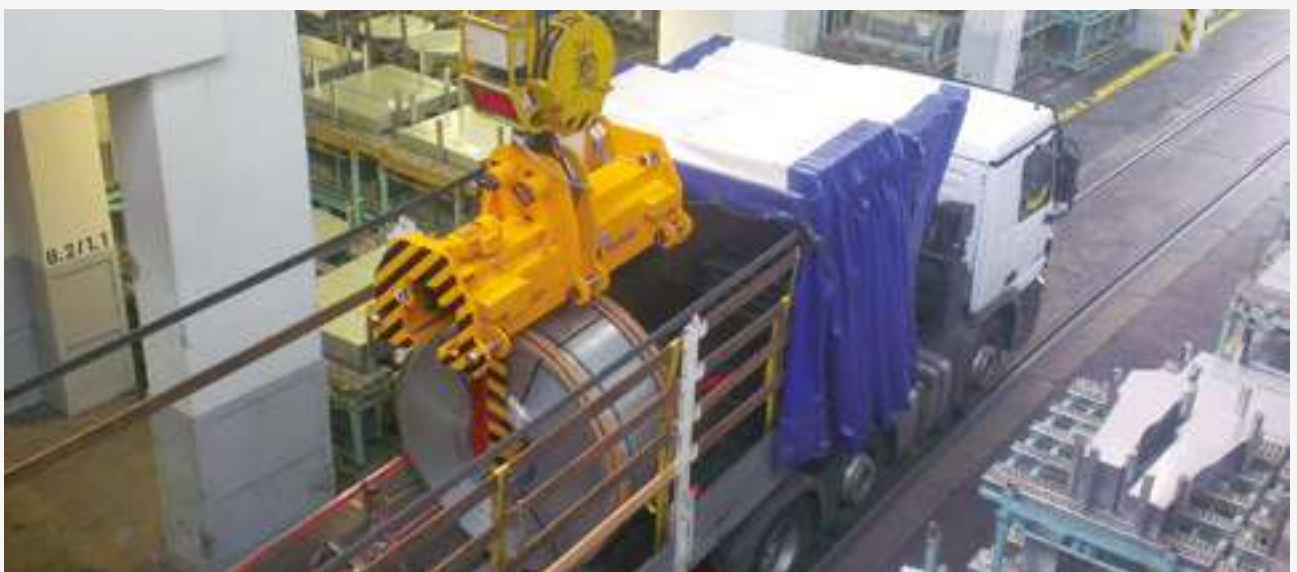
Teleskop-Coilzange mit Spindeltrieb für den Transport von Coils und Presswerkzeugen Telescopic coil gripper with spindle drive for transporting coils and press tools
