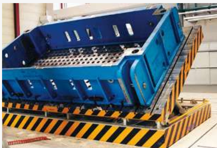
Scherenhubtisch mit Schwenkplatte, hydraulisch angetrieben, für gute Zugänglichkeit bei Arbeiten an Presswerkzeugen. Die Einrichtung ist bis auf Hallenbodenhöhe versenkbar
