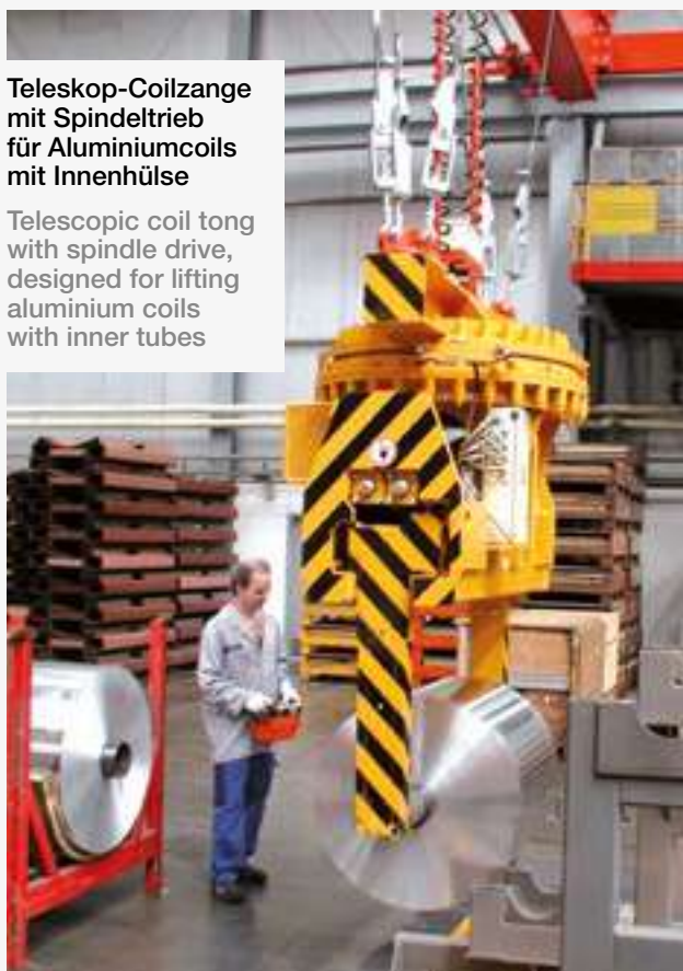
Teleskop-Coilzange mit Spindeltrieb in besonders niedriger Bauweise
