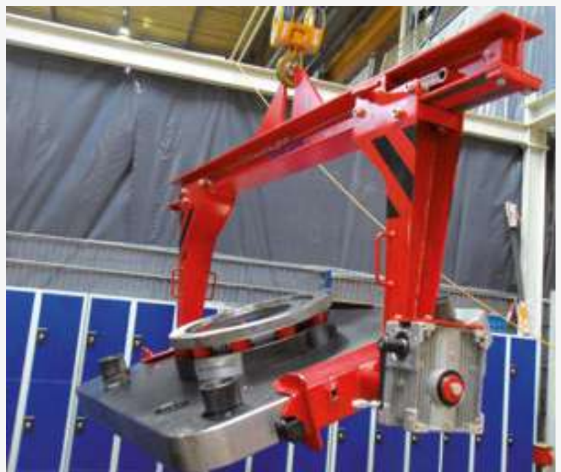
Wendetraverse in mechanischer Ausführung
