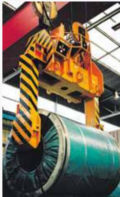
Teleskop-Coilzange mit Hydraulikantrieb und klappbaren Aufnahmepratzen
