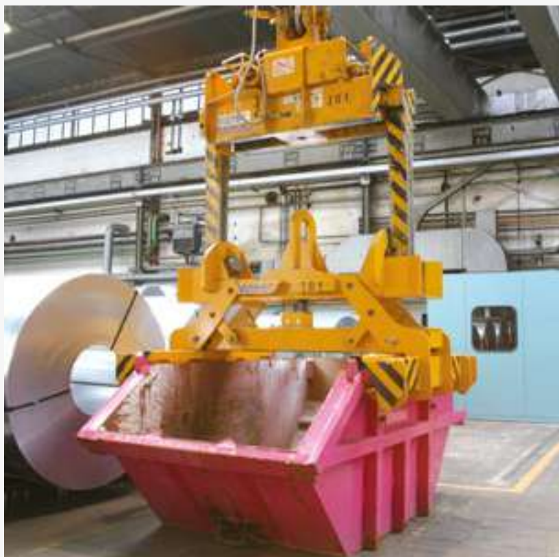
Schrottcontainerzange in Scherenbauweise mit Aufhängeadapter zur Aufnahme mit einer Coilzange
