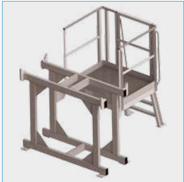
Abstellbock mit Wartungsbühne Stand with maintenance platform
