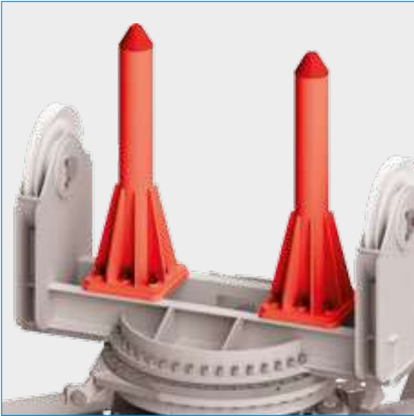
Verriegelung der Blechkpaketzange in oberster Kranhubstellung Für pendelfreie Kran- und Katzfahrt
